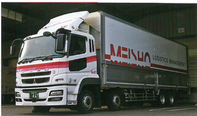
キャビンを短くすることで荷台スペースを広く確保した、大型四軸低床ウイング車。 主に冷凍食品の配送を行っている小型の冷蔵冷凍車。
