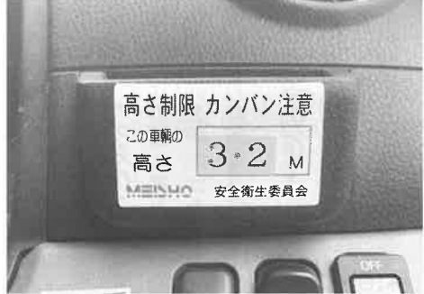
▶運転席から見える場所に車両の高さを掲示して見える化を推進
